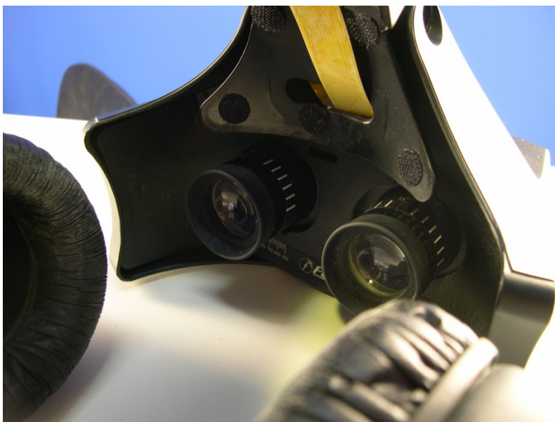
Figura 4: sistema ótico para focar os LCDs do VFX1 Fonte: foto do autor
