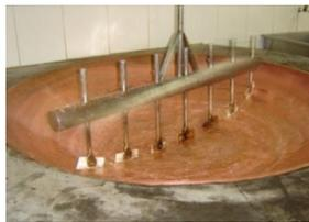
**Figura 60:** Processador para fabricação de geléias.
